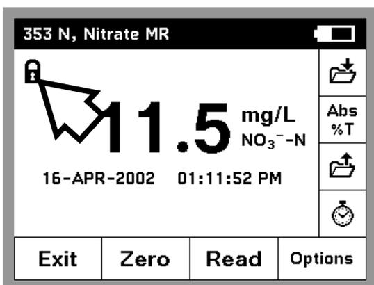
这个功能允许操作者在“Push-to-Read (按键读数)”和“Continuous Display (连续显示)”两种模式中进行选择。默认的设置是“Push-to-Read (按键读数)”。在这种模式下,“Push-to-Read (按键读数)”显示锁是打开的, 屏幕上将显示一个挂锁的图标。
